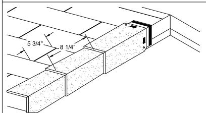
RAKE EDGE INSTALLATION: EZ-RIDGE SHINGLES CAN ALSO BE INSTALLED ON RAKE EDGES. INSTALL RAKE EDGE SHINGLES BEFORE RIDGE SHINGLES.
